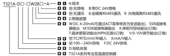
注: 选型时应注明输入信号类型: 第一种: TC/RTD/mV/Rt; 第二种: mA/V。
